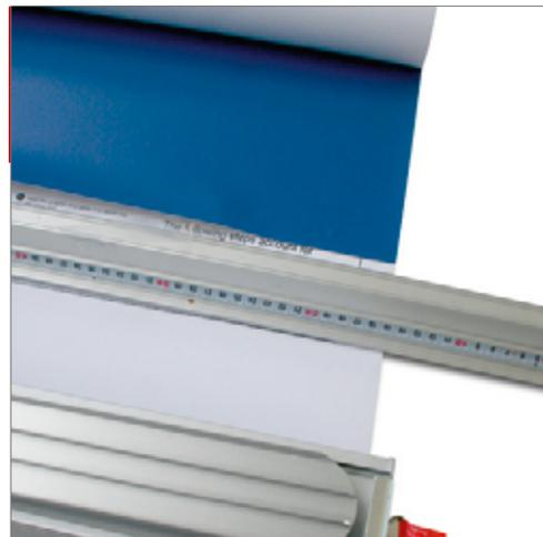
Nun können Sie die Klemmschiene an dem neuen Druck befestigen.
